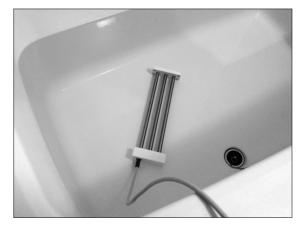
▲ ヒーターを浴槽の底に寝かせた状態セットします。底に沈めることで、空焚き予防になるだけでなく、浴槽内に対流が発生し、はられた水をまんべんなく温めることができます。
