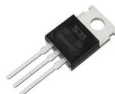
足を直角に折り曲げ、基板の刻印に合わせて寝かすように取り付けます。ハンダ付け後は余った足をニッパーで切っておきます。
