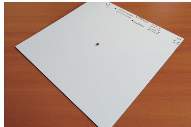
基板の裏面中央には温度センサーが実装されています。組み立ての際は丁寧に扱ってください。
